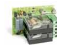
EPS1-009 Tarjeta receptora para lámpara destellante en cuadro básico EP1M. 38,41 €
