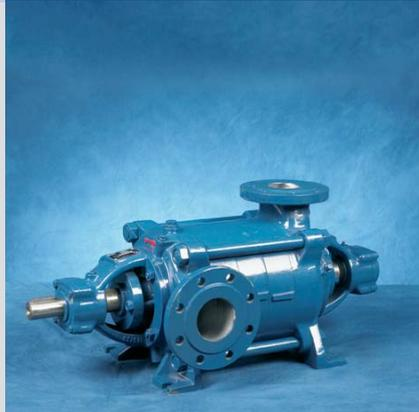
Bomba centrífuga multicelular de media presión, con estanquidad del eje por empaquetadura o cierre mecánico. Para impulsar aguas limpias no abrasivas o fluidos limpios.
