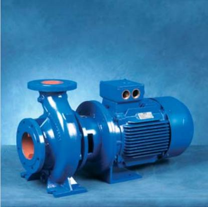
→ Electrobomba centrífuga en ejecución monobloc según DIN 24255, rodete cerrado, sellado con cierre mecánico y motor normalizado. Para servicio de calefacción, riegos, aire acondicionado, agricultura y aplicaciones generales. Construcción en los materiales más adecuados al fluido a impulsar.
