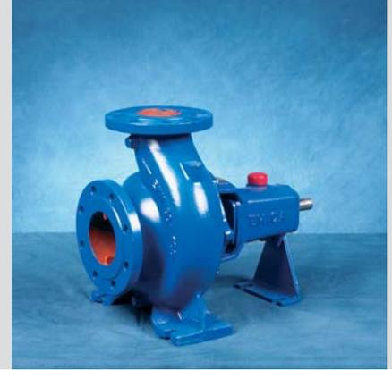
Bomba centrífuga según DIN 24255, rodete cerrado, sellado con cierre mecánico o empaquetadura. Para líquidos limpios sin componentes sólidos ni abrasivos. Construcción en los materiales más adecuados al fluido a impulsar.
