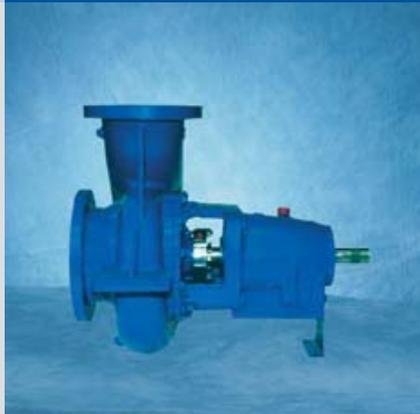
→ Bomba centrífuga construcción de proceso según API 610 o VDMA 24297, grado de exigencia «A heavy duty». Para elevación de hidrocarburos en refinería a industria petroquímica. Estanqueidad del eje por cierres mecánicos de diferentes marcas y ejecuciones. Construida en los materiales más adecuados.
