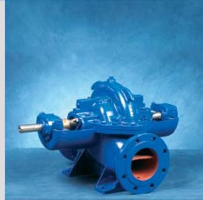
Bomba centrífuga de cámara partida, rodete radial de doble flujo, monocelular empujes axiales equilibrados. Para servicios de riegos, abastecimientos e industria en general. Estanquidad del eje por empaquetadura o cierres mecánicos.
