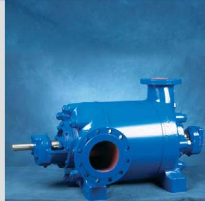
Bomba centrífuga multicelular de alta presión, con compensación del empuje axial por rodamientos o pistón. Estanquidad del eje por empaquetadura o cierre mecánico.
