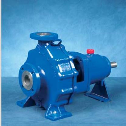
Bomba centrífuga en construcción de proceso según DIN 24256, ISO 2858, EN 22858 o bien ISO 5199, cierre del eje por empaquetadura o cierre mecánico. Servicio en procesos químicos y petroquímicos y otras aplicaciones. Construcción de serie en diferentes materiales según necesidades.
