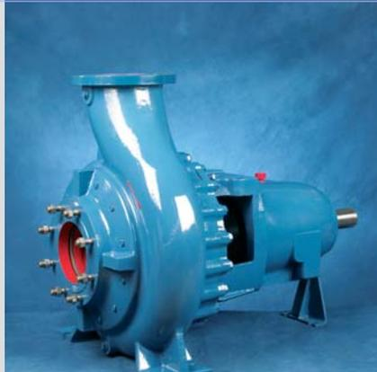
Bomba centrífuga en ejecución de proceso con rodetes de canal, cumple con la norma DIN 24256, abierto o vortex, adecuados para impulsar fluidos cargados, suspensiones celulósicas, aguas fecales y mezcla de agua con minerales. Construidos en distintos materiales adecuados al fluido a impulsar.
