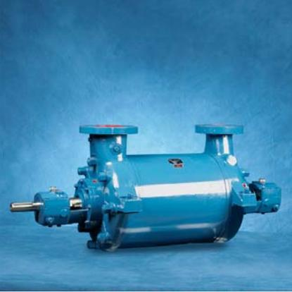
→ Bomba centrífuga multicelular de alta presión. Estanquidad del eje por empaquetadura o cierre mecánico. Para alimentación a calderas, impulsión de condensados o fluidos limpios. Construcción en distintos materiales acorde con el fluido a impulsar.
