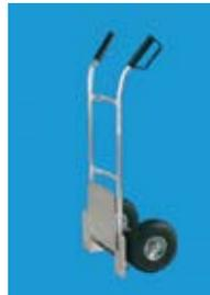
Carro profesional en aluminio. Dotado de protector de mano para mayor seguridad. Neumáticos de goma de 260 mm. de diámetro, parte central y rodamientos en hierro. La estructura está formada por robustos tubos soldados de 25 mm. de diámetro. Dispone de plataforma plegable para el transporte y almacenaje en sitios reducidos. Con refuerzo plano en el tubo del marco interno.
