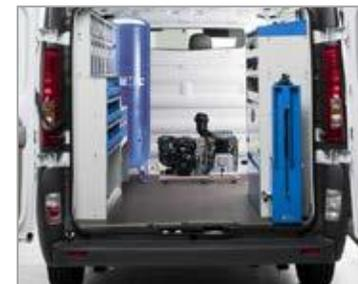
Sugerencia de montaje en vehículo con depósito de 270 litros.
