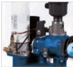
La solución integrada del nuevo grupo de tornillo garantiza las mejores prestaciones de la categoría, una alta eficacia y fiabilidad. Unidad de compresor monotapa refrigerada, estudiada para obtener una amplia accesibilidad en mantenimiento.
