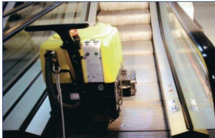
Fregadora-secadora indicada para todo tipo de escaleras mecánicas. Sin detener la escalera, limpia y seca con efectividad toda la suciedad.
