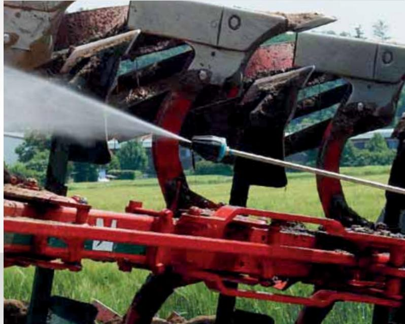
Fig. lanza de Turbo-eliminador
