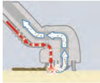
Limpeza, aspiración con vapor y aspiración en seco en sólo un paso
