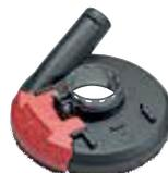
Permite trabajar cerca de los bordes con la máxima potencia de aspiración. El ajuste de altura con un tornillo Allen, permite adaptar rápidamente la campana de aspiración a la altura de la herramienta. Nota: para trabajar con la protección y disco de diamante recomendamos una amoladora angular de 1500 W mínimo.
