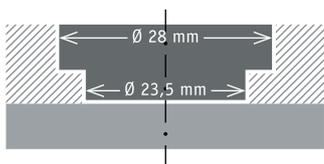
Nota: todos los discos de lijar para la WST 1000 FV y WS 1515 FR con acoplamiento especial. Debido a su peso ligero, que protege la máquina, y al acoplamiento especial, se deberá usar la tuerca de sujeción Fixtec para una fijación segura en el eje de salida.
